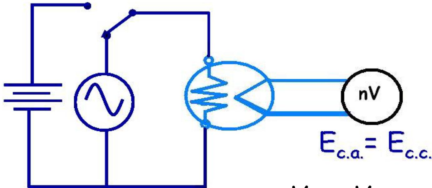
$$V_{c.a.} = V_{c.c.} * (1 + \delta)$$
