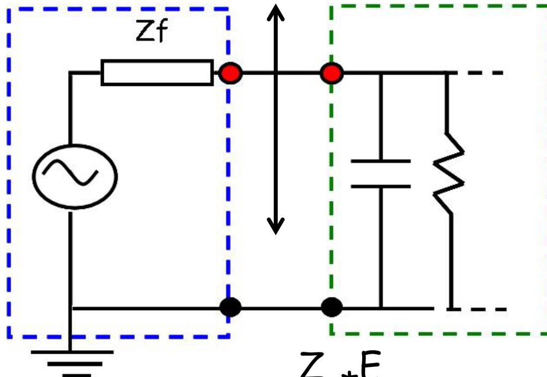
$Z_f < 5\text{m}\Omega$  para  $V > 330\text{ mV}$
