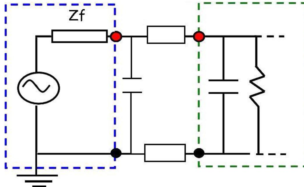
La capacitancia de los cables crea efectos de derivación de corriente y su impedancia una caída de tensión.
